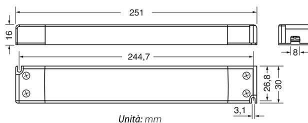
LED driver in tensione costante adatto ad alimentare strisce a LED o faretto in tensione costante.
