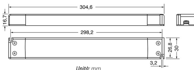
LED driver in tensione costante adatto ad alimentare strisce a LED o faretto in tensione costante.
